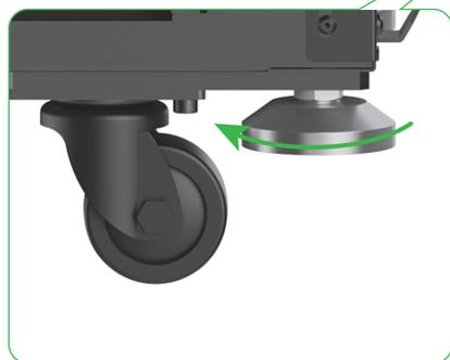
手動順時針旋轉水平腳座，直到它們接觸地面。
