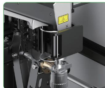
(5) 將焊槍線纜上的三個固定環依序卡入機器內部的固定槽
